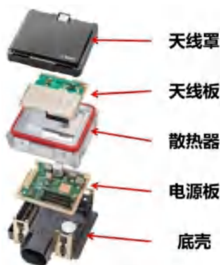
图表：BOSCH 的第四代毫米波雷达的结构：
