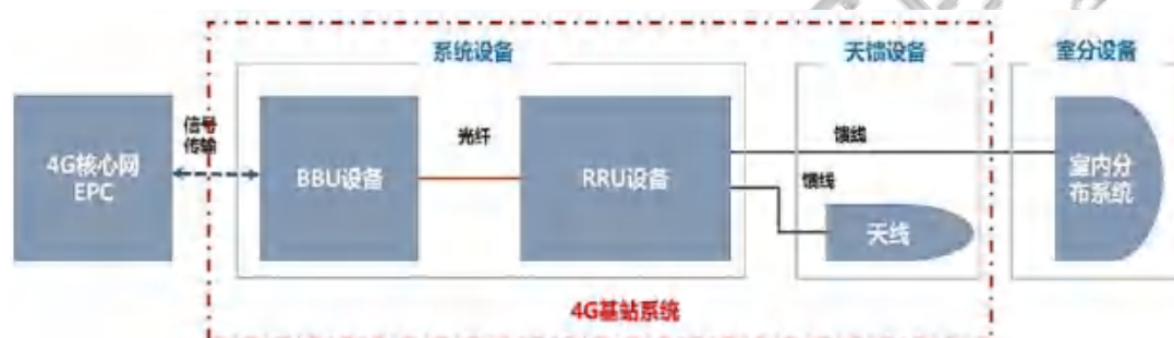
图表 传统基站构成示意图
